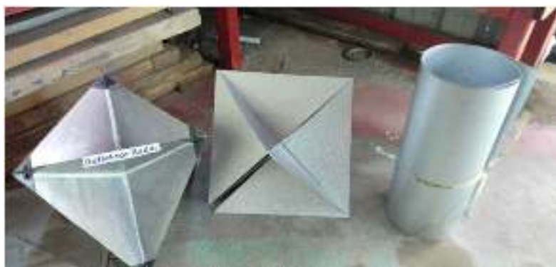
Gambar 3. Bentuk bahan aluminium dan radar reflector yang sudah jadi
