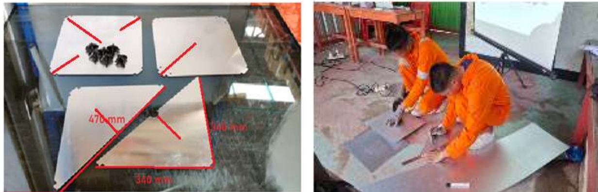
Gambar 2. Template dan pembuatan radar reflektor tipe octahedral
