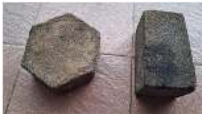
Gambar 2 Paving Blok Berbahan Limbah Plastik (PET dan LDPE)
