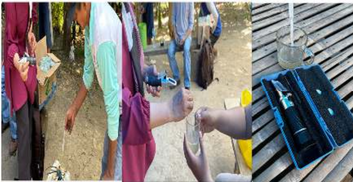
Gambar 02. Hands on Pelatihan pengukuran Kadar gula ( °Brix ) dengan menggunakan refraktometer
