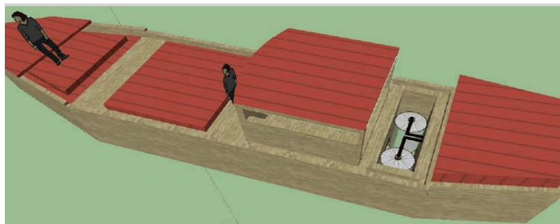
Gambar 3. Rancangan Penggunaan Biogas pada Kapal Ikan
