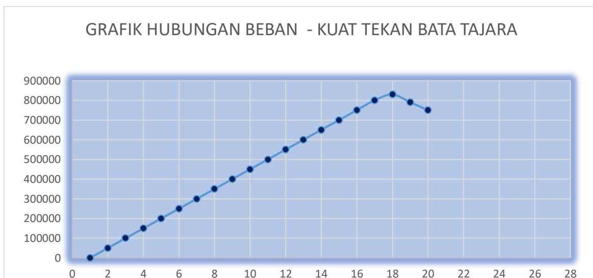
Gambar 1. Hubungan Beban - Kuat Tekan Bata Tajara
